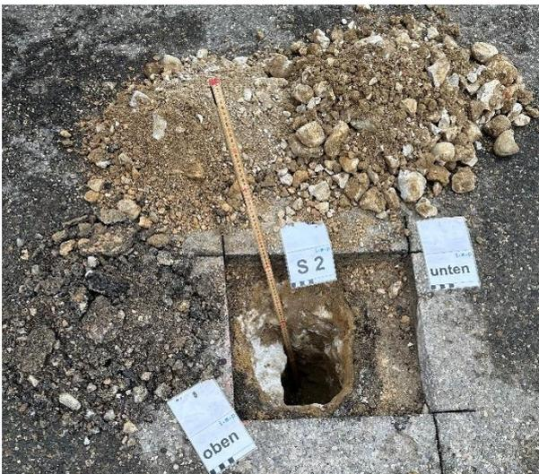
Bild 6: Aushubmaterial S2 / S2.1 ca. 0.11 - 0.65 m.
