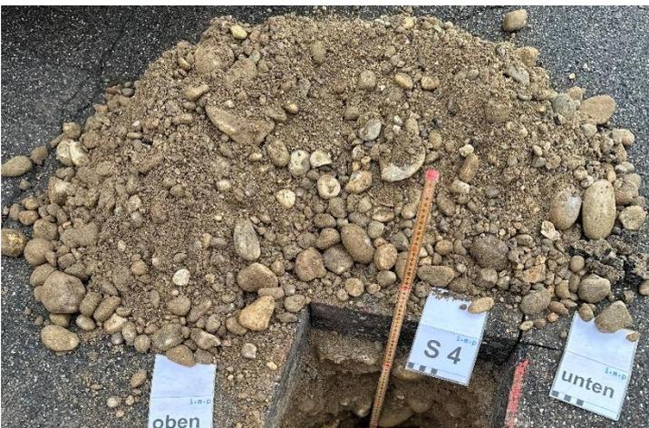
Bild 12: Aushubmaterial S4 / S2.1 ca. 0.10 - 0.75 m.
