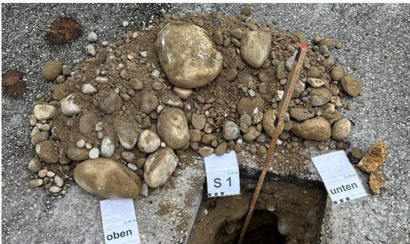
Bild 3: Aushubmaterial S1 / S1.1 ca. 0.08 - 0.80 m.
