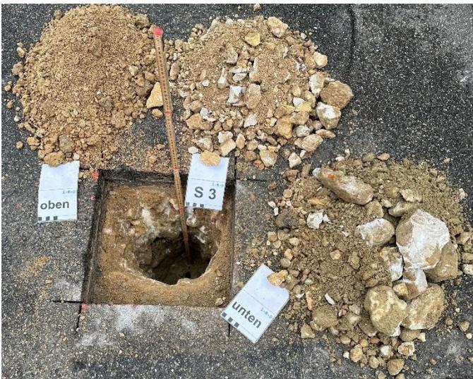
Bild 9: Aushubmaterial S3 / S3.1 ca. 0.08 - 0.60 m.
